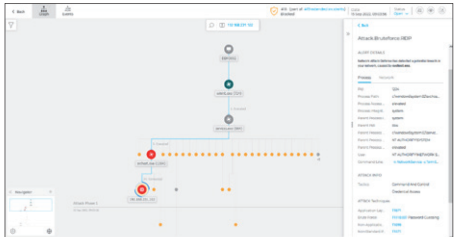
Obr. 1: ukázka detekce probíhajícího útoku v EDR incidentu – úspěšný bruteforce útok na RDP
